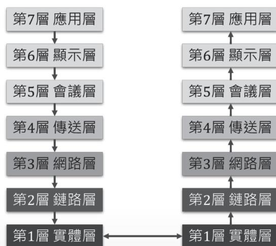
圖(一) OSI網路互聯通信模型
