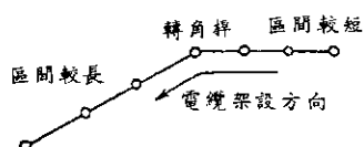
圖 4-11 轉角桿電纜架設
