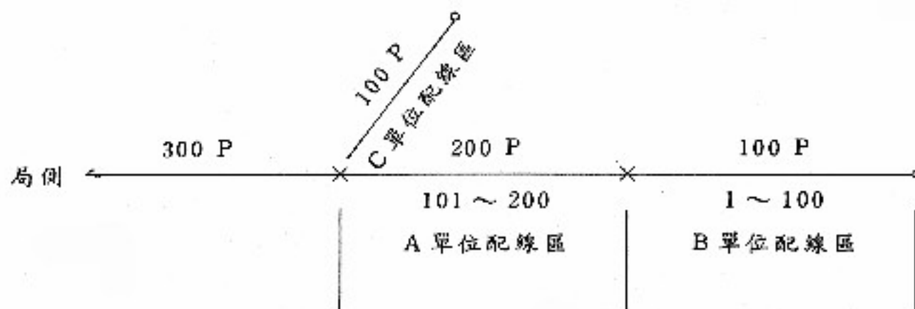
圖(2-1) 地下線路單位配線區設計例
