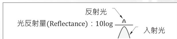
連接器依端面分類，有：平面，回流損失30dB、超端面、55dB，斜角端面，65dB。平面連接器，接觸面大，故反射量大，約有千分之一的光被反射。
