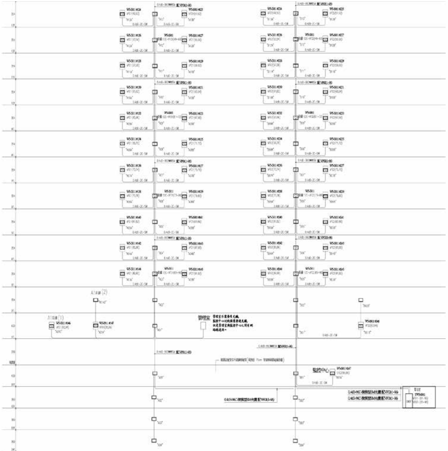
光纖 配線位置
