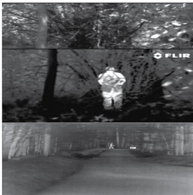
使用紅外線熱顯像儀，能看到肉眼所不能見的物體，提供細微溫差的視覺影像，可讓使用者具備『黑暗中的視覺』，因此對保全、監視、執法、搜救、農業，觀測不可見的熱源，比較相對溫度，透視煙霧以及需要強化感知與提高警覺的其他作業帶來革命性的變化。
