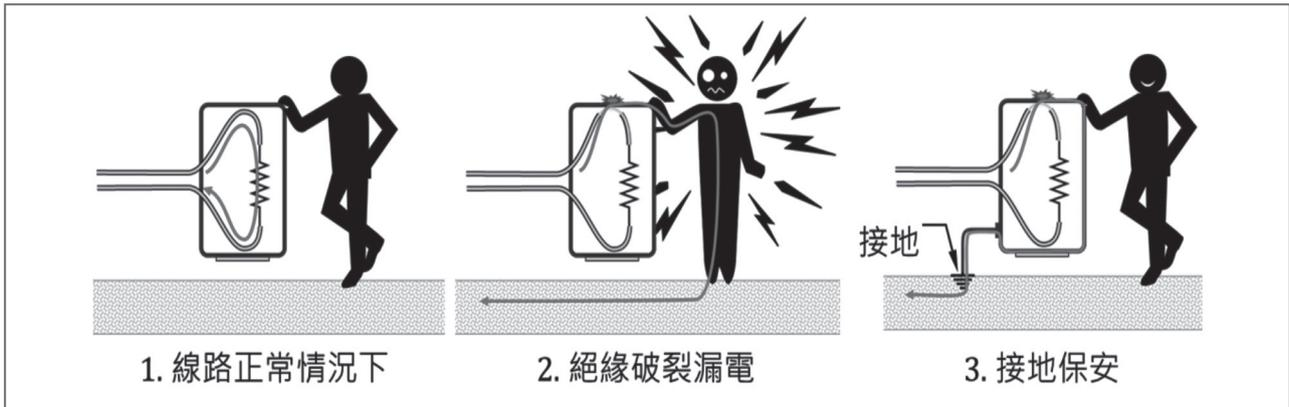
圖(一) 保安接地示意圖
