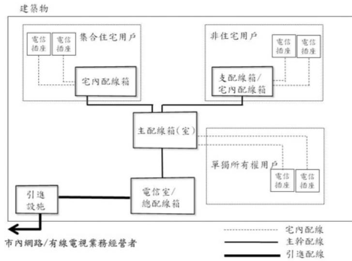
圖3-2一般建築物電信設備架構圖
